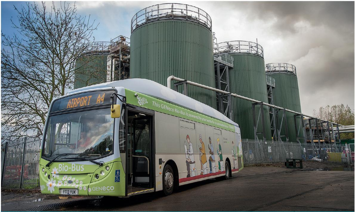
El Bio-Bus, operado con biogás producido en una planta de tratamiento centralizada de alcantarillado, Reino Unido. Fotografía: Wessex Water
