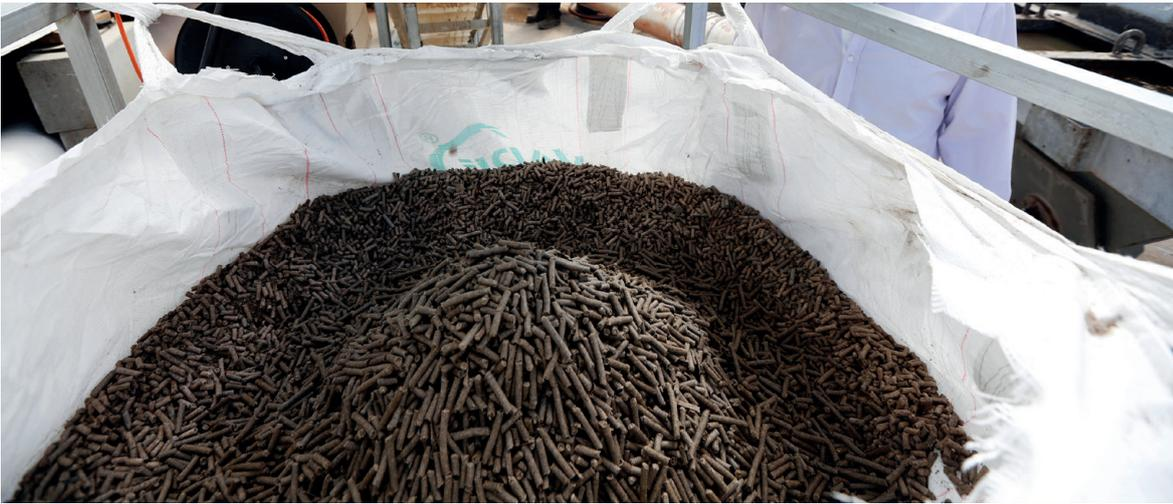
Gránulos de fibra de celulosa recuperadas del alcantarillado. Estos gránulos, comercializados bajo el nombre de Recylose, se pueden utilizar como combustible o en la producción de papel, aislamientos, materiales de construcción y bioplásticos. Fotografía: Reuters / Baz Ratner
