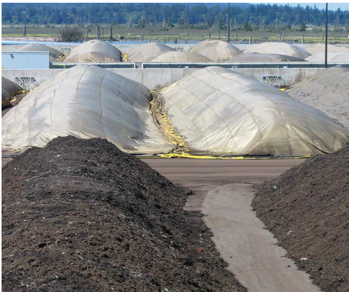
13 Figure IV-3 : Technologie de compostage en andains aérés passivement : GORE
