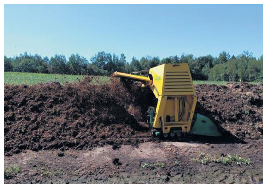
10 Figure IV-2 : Technologie de compostage en andains retournés
