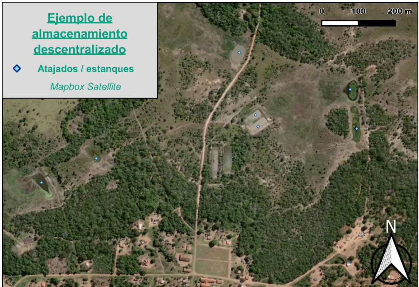
Figura 2. Un ejemplo de algunos de los atajados (estanques de almacenamiento de agua) desarrollados para abreviar ganado y abastecer de agua para uso doméstico a áreas que antes eran bosque seco Chiquitano.
