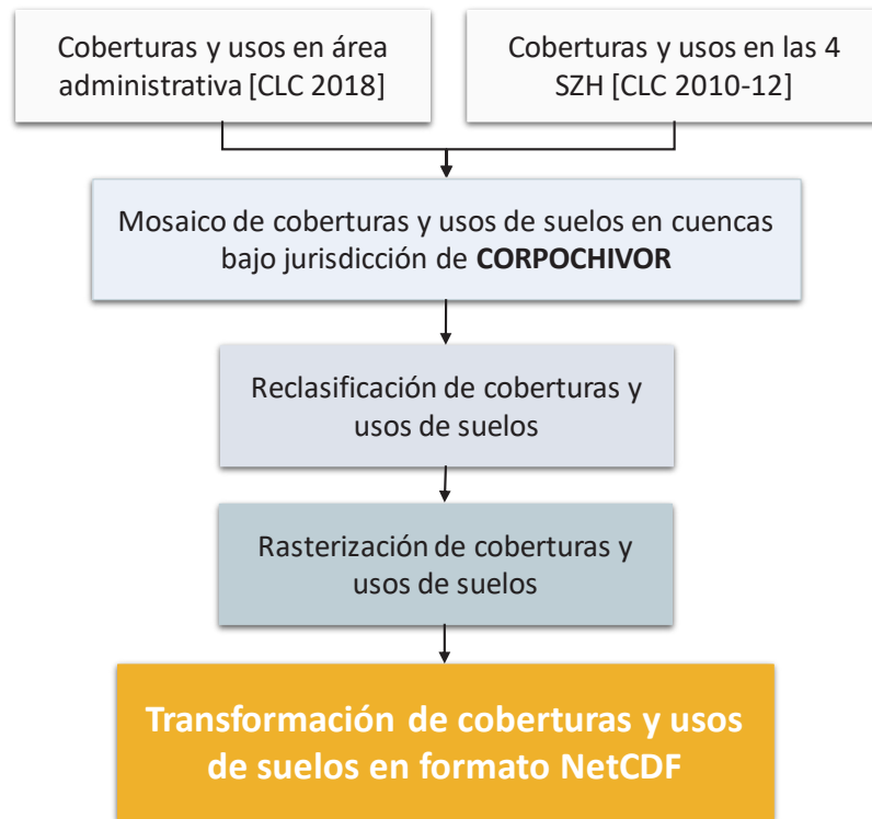
Figura 7. Diagrama de flujo para la reclasificación de las categorías de coberturas y usos de suelos en el área de drenaje de las cuatro subzonas hidrográficas que hacen parte de la jurisdicción de Corpochivor
