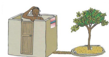
Infiltration de l'eau de la douche autour d'un arbre
