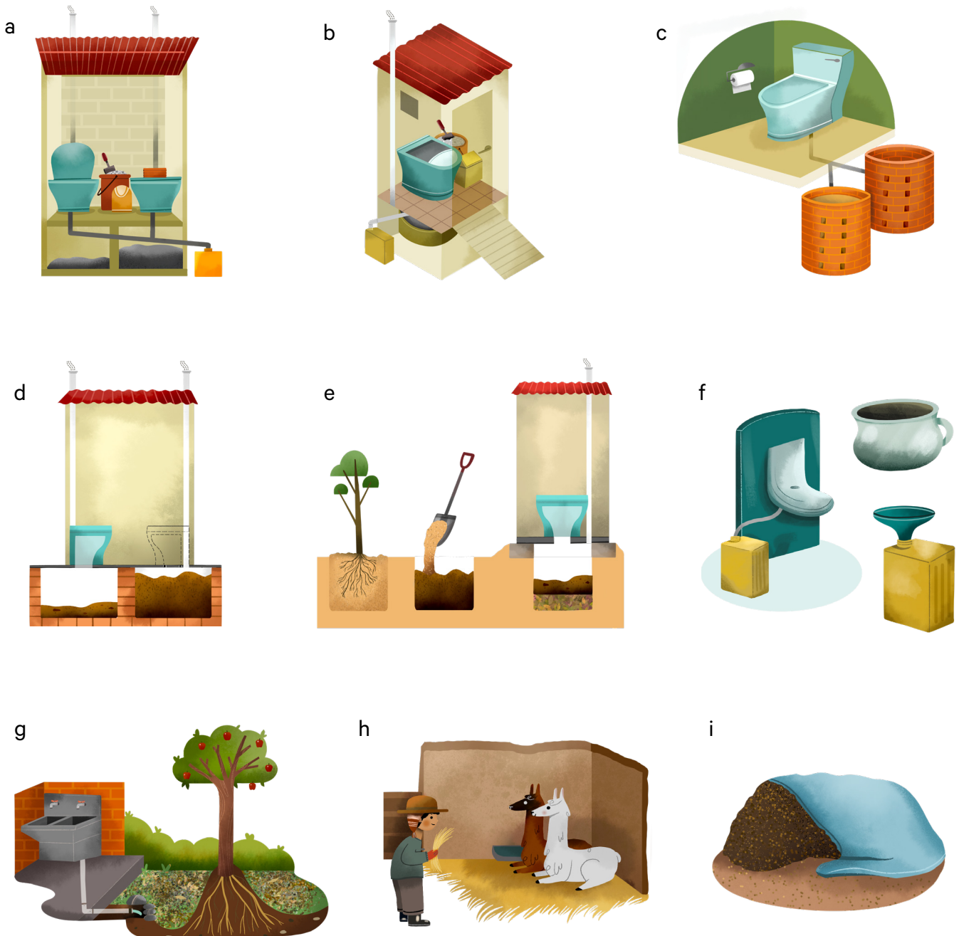
Figura 3. Ejemplos de opciones tecnológicas que permiten la reutilización en zonas rurales : a) Inodoro seco de doble cámara con desviador de orina: las heces se pueden vaciar después de 6 a 12 meses si se ha agregado ceniza; b) Inodoro seco con recipientes móviles donde las heces se compostan en otro lugar durante al menos 12 meses c)+d) Dos tipos de inodoro de pozo doble que se pueden vaciar después de >2 años; e) Arborloo con compostaje y plantación de árboles en antiguos pozos; f) Urinarios para complementar los inodoros sin desviador de orina (c, d, e) para mejorar la recuperación de nutrientes; g) Ejemplo de aguas grises infiltrada en un lecho de mantillo alrededor de un árbol; h) Uso de cama de paja para absorber la orina del ganado; i) Una pila de compostaje para el compostaje de residuos orgánicos del hogar.
